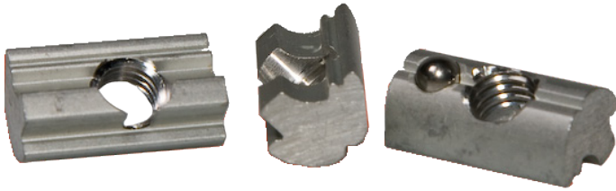
Nutenstein aus Aluminium (SCHÜCO-kompatibel) zur Montage von Photovoltaik-Anlagen einschwenkbar für Profil Nut 8
